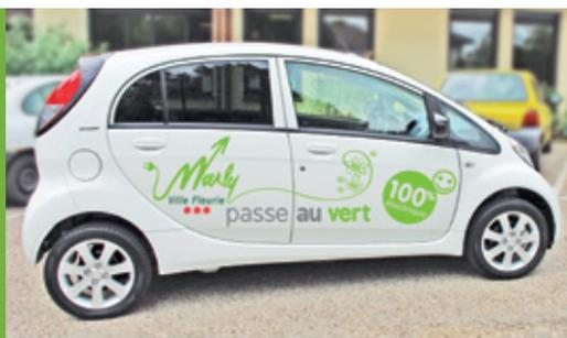
*La Peugeot ION fait désormais partie du parc de véhicules de la municipalité. Sans émission de carbone, cette voiture est équipée d'un petit moteur électrique développant 47 kW (64 ch) pour une autonomie de 100 km environ. En 2013, c'est la Zoé de Renault qui a été acquise. Une initiative supplémentaire pour le développement durable !*
